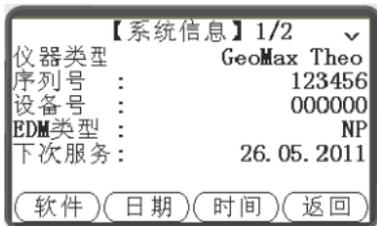
软件 显示仪器上安装的固件包细节信息。
